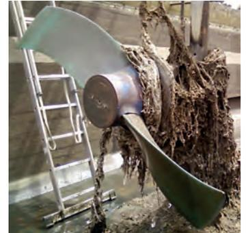
Wir ersuchen Sie eindringlich, unsachgemäße Entsorgungen von Müll durch Abflüsse oder Toiletten zu unterlassen. Verstopfungen und Verunreinigungen von Pumpen (siehe Foto oben) können Schäden oder zumindest erhebliche Wartungskosten verursachen. Dies schlägt sich selbstverständlich auch auf die Kanalgebühren nieder.
